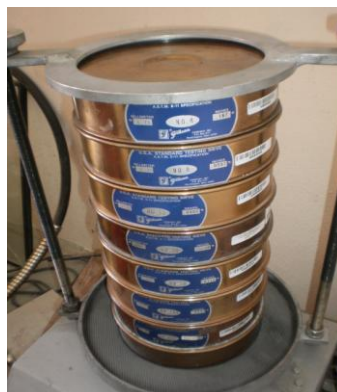
Figura nº 6 - Fotografia dos peneiros na separação dos agregados finos/grossos
