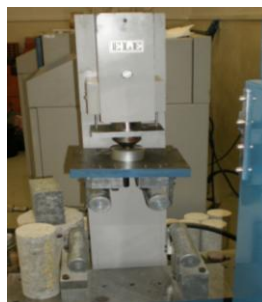
Figura nº 23 – Fotografia da máquina de ensaios à flexão para o 1º ensaio
