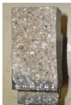
Figura nº 11 - Fotografia corte transversal do provete B armado com malha
