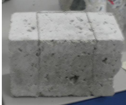
Figura nº 56 - Fotografia do provete com a 1ª matriz cimentícia em ensaio à compressão
