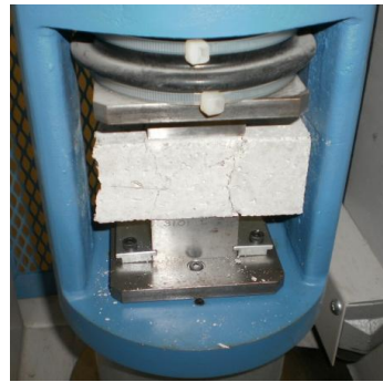
Figura nº 55 - Ensaio à compressão provete (40mmx40mm)
