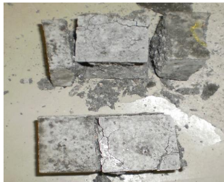
Figura nº 58 - Fotografia do provete com a 2ª matriz cimentícia em ensaio à compressão
