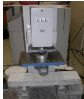
Figura nº 25 - Fotografia da máquina de ensaios à flexão para o 2º e 3º ensaio
