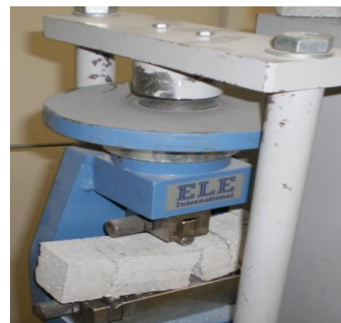
Figura nº 54 - Ensaio à flexão com os provetes prismáticos
