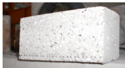
Figura nº 31 – Corte transversal do provete A em BAM
