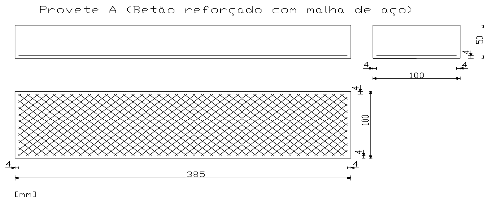
Figura nº 14 - Planta do provete A: BAM
