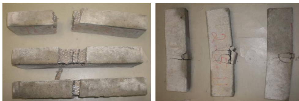
Figura nº 41 - Fotografias do ensaio aos 28 dias com os provetes B em BAMU
