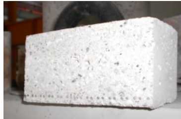
Figura nº 10 - Fotografia representa o corte transversal do provete A armado com malha
