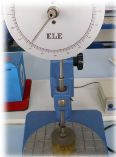
Figura 24 - Ensaio do cone penetrométrico
