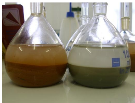
Figura 27 – Amostras nos picnómetros
