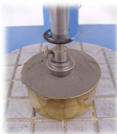
Figura 25- Determinação do limite de liquidez através do cone amostra P 1
