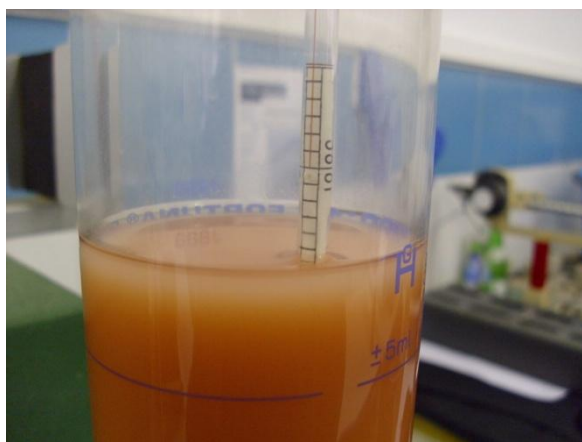
Figura 29 - Leitura com o densímetro
