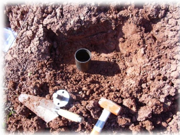
Figura 17 – Recolha com amostrador
