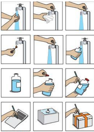
Ilustração 5 - Passos a seguir na colheita de uma amostra de água de abastecimento
