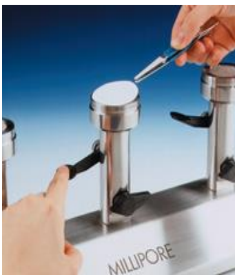
Ilustração 6 - Técnica da membrana filtrante
