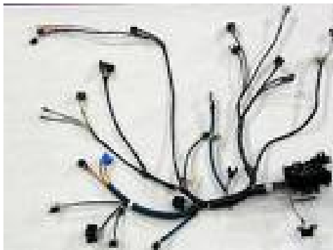
Fig. 4 Exemplo de uma cablagem
