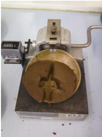
Fotografia 13 - Concha de Casagrande (determinação dos limites de consistência NP-143/1969)
