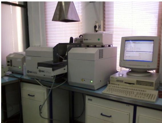
Fotografia 20 - Espectrofotômetro de absorção atômica por camara de Grafite
