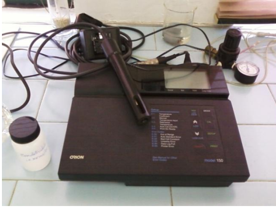
Fotografia 19 – Sonda de condutividade usada no laboratório, Orion modelo 150
