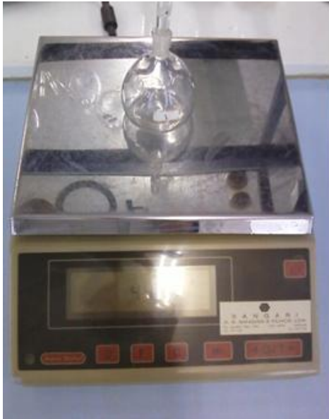
Fotografia 8 Balança e picnómetro -
