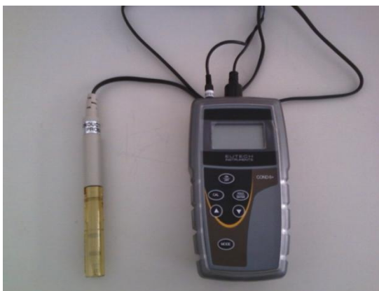
Fotografia 18 – Sonda usada na determinação da condutividade (Cond 6/TDS 6, EUTECH instruments OAKION)
