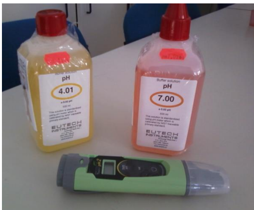
Fotografia 17 – Sonda usada na determinação do pH (Eco testr pH2, EUTECH instruments OAKION)
