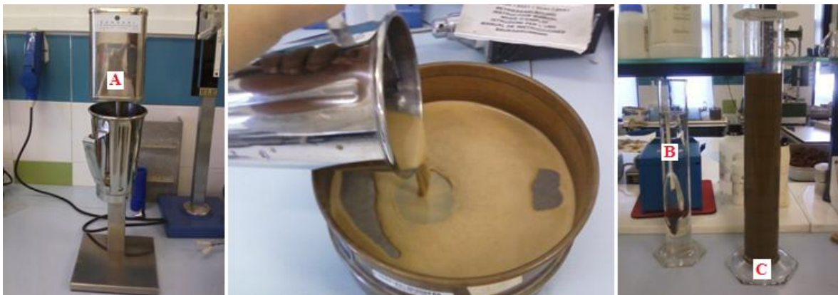
Fotografia 10, 11 e 12 - Análise granulométrica E 196-1966 -- agitador elétrico (A), densímetro (B), Proveta graduada (C)
