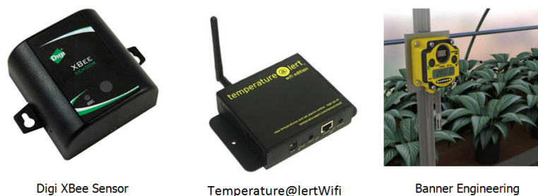
Figura 4.1: Equipamentos para leitura da temperatura e envio sem fios, adaptado de [5][4].
