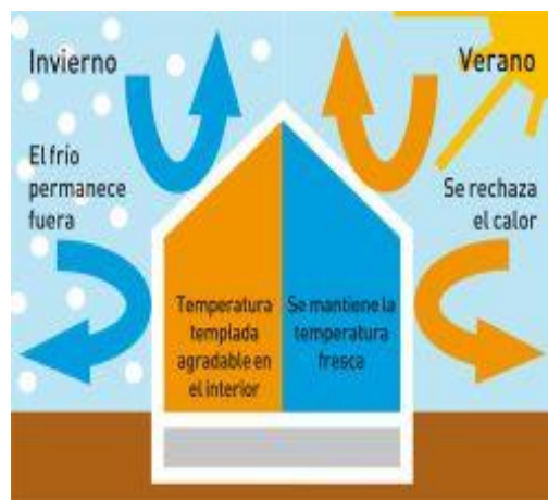
Figura 1.19- Funcionamento da inércia térmica. Fonte: http://www.xellaus.com/html/esp/es/5499.php
