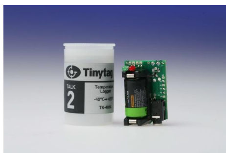
Figura 4.6- TinyTalk, aparelho de medição de temperatura.
