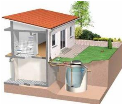
Figura 2.22- Reservatório enterrado. Fonte: http://www.arq.ufsc.br/arq5661/trabalhos_2007-1/pluviais/Topico4.htm
