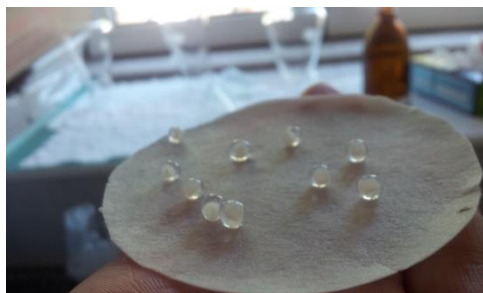
Imagem 4. Partículas de Quitosano a 2% revestidas com Alginato a 1%
