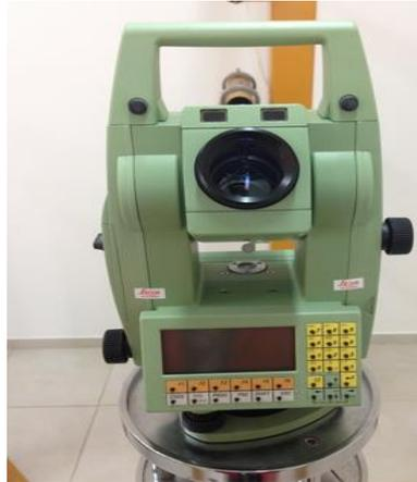
*Figura 7- Estação total TC1100-Leica*
