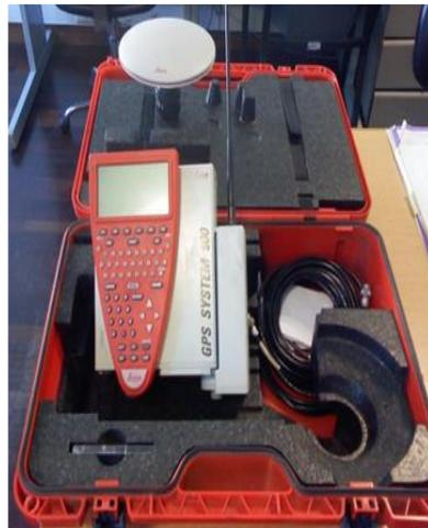
*Figura 8- GPS-Leica System-400*
