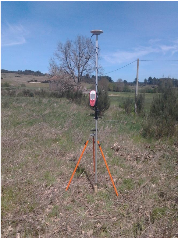
Figura 29 - Coordenação de um Ponto de Apoio.
