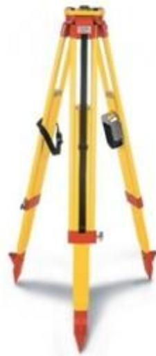
Figura 3 - Tripé que suporta estação total ou GPS.
