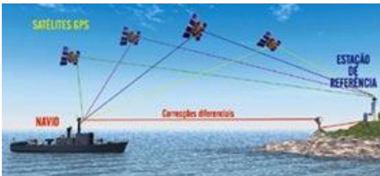
Figura 15 - Esquema de funcionamento do sistema DGPS aplicado ao posicionamento em navegação.
