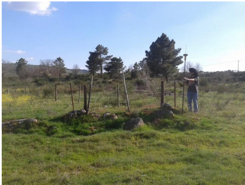
Figura 38 - Aquisição dos pontos topográficos para definição do pormenor.
