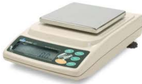
Figura 15 - Balança de gramagem, modelo BK-600 (Fonte: http://www.qualitylabor.com.br/produtos/papel/balanca-de-gramatura ).
