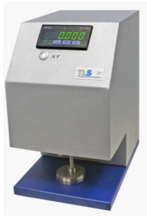
Figura 16 - Micrómetro para papel (Fonte: http://www.metrotec.es/metrotec/WWW_DOC/6676_M6P-1-CAT-E-R1.PDF ).
