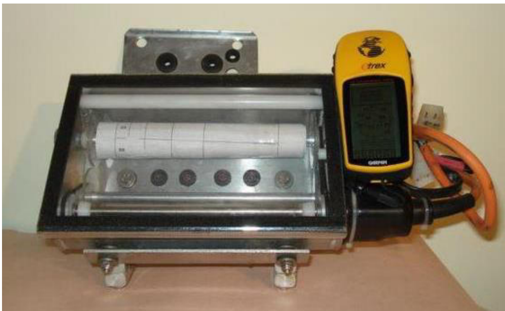
Figura 13 - Dispositivo enrolador de roadbook com GPS acoplado 13
