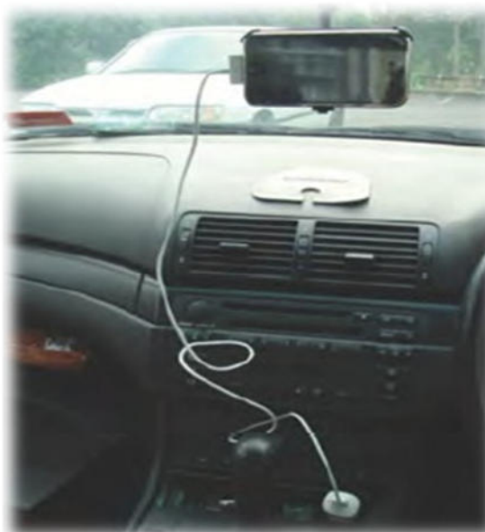
Figura 6. Localização do smartphone iPhone dentro do veículo (adaptada de Ren et al. (2012))
