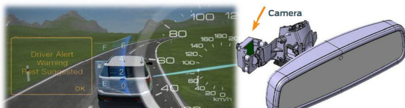
Figura 2. Sistema de deteção de cansaço através de uma câmara instalada no para-brisa do veículo (adaptada de Ford (2013))
