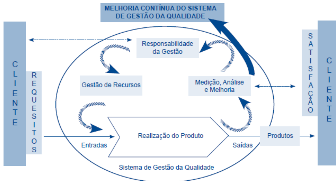
Figura 5 - Modelo de um sistema de gestão da qualidade baseado em processos (NP EN ISO 9001:2000)
