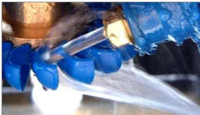
Figura 9 - Injetor em funcionamento numa turbina Turgo [Fonte: renewablesfirst.co.uk]
