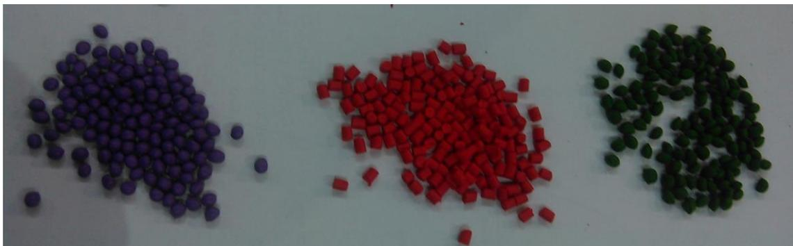
**Figura 7** - Matérias- primas - Colorizantes (PP, PE, PVC) [3]
