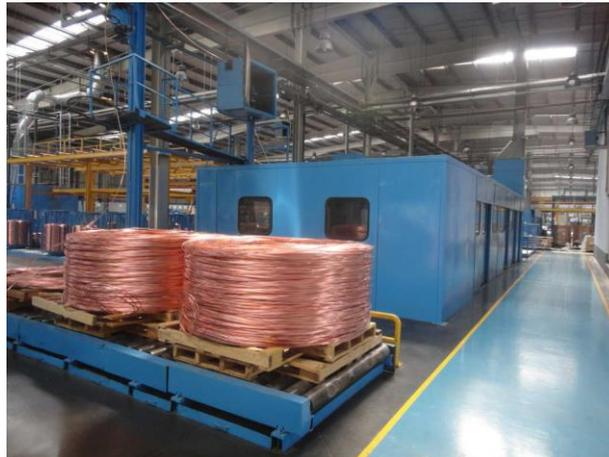
**Figura 8** - Trefiladora Pesada
