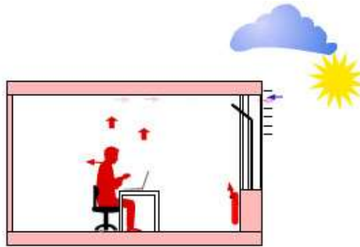
Figura 11 - Ventilação de um só lado Fonte: [13]
