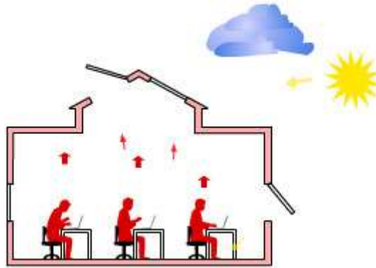
Figura 13 - Ventilação por convecção Fonte: [13]
