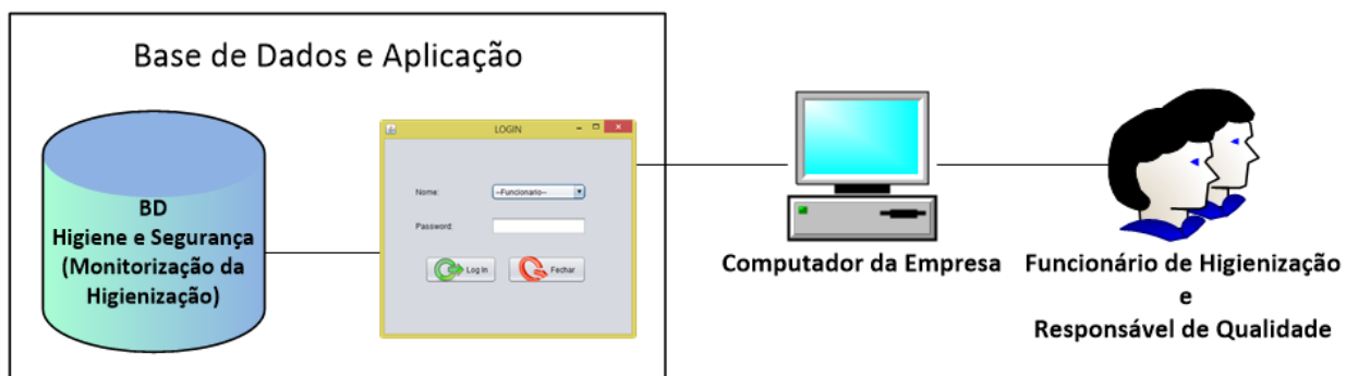
Figura 12: Diagrama de Instalação do Sistema de Monitorização da Higiene
