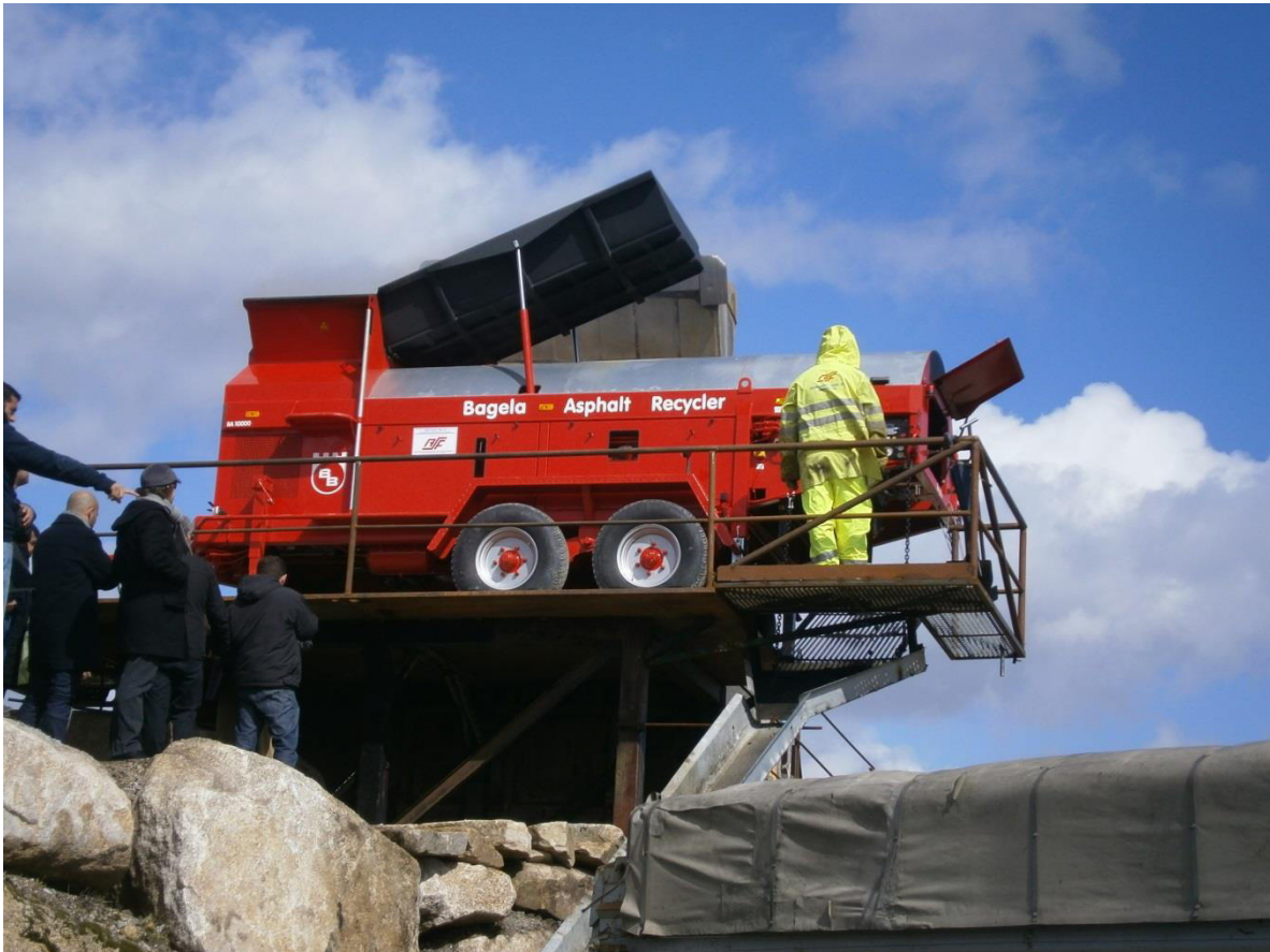
Figura 3: Recicladora de material asfáltico fresado.
