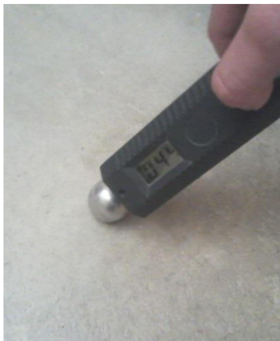
Figura 30: Exemplificação de utilização do equipamento de medição de humidade.
