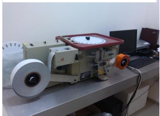
Figura nº10- Máquina de reembalagem de formas orais sólidas fracionadas: Medical Packaging, Auto Print- Unit Dose Systems®
