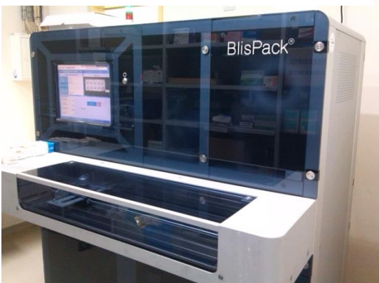
Figura nº9- Máquina automática para reembalar formas sólidas inteiras: Blis Pack®•Grifols
