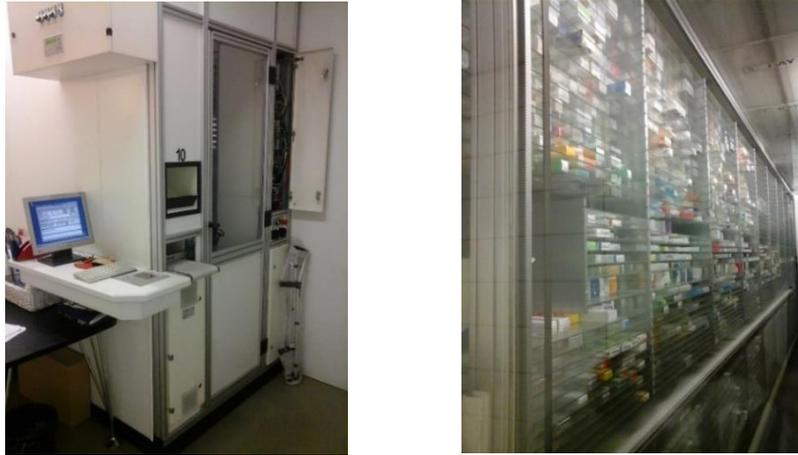
Figura 6 - Robot Rowa® e armazenamento no interior do mesmo
