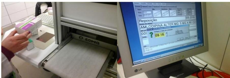
Figura 8 - Introdução de um medicamento no *robot*
