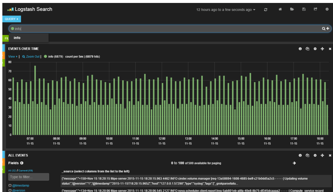
Figura 38 - Interface do Kibana para gestão centralizada dos logs
