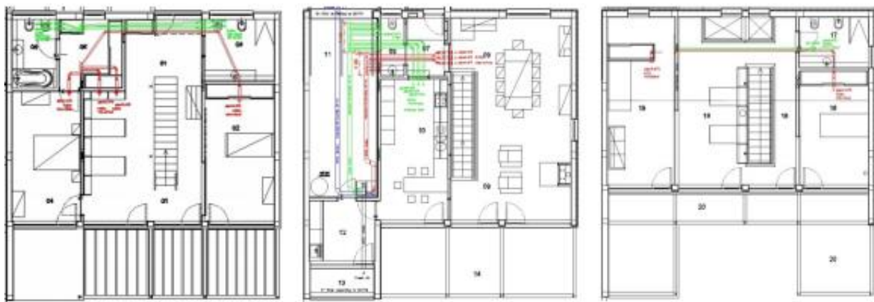
Figura 34 - Esquema de condutas de extração e insuflação de ar na moradia B [37]
