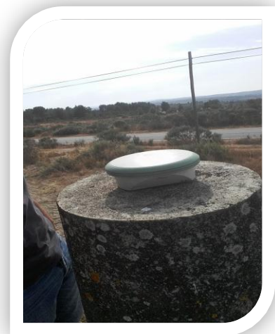
Figura 11 - Base do equipamento GNSS Leica RX1200 estacionada sobre o Vértice Geodésico Espírito Santo
