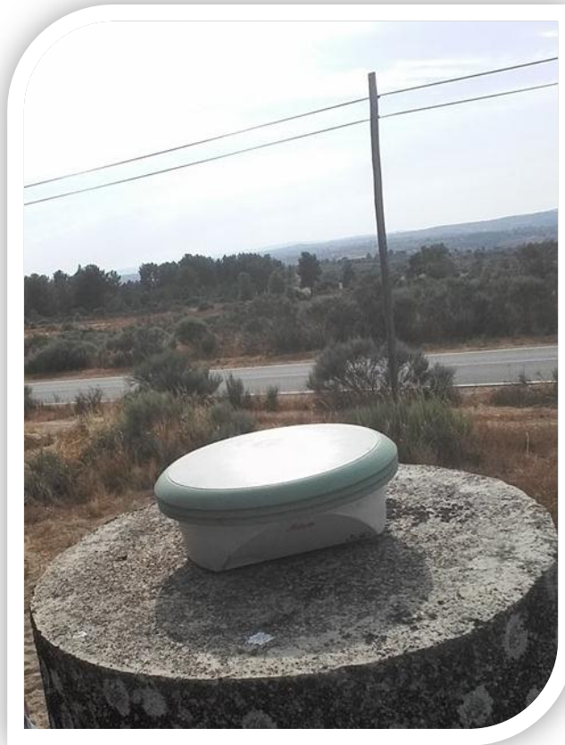
Figura 34 - Antena Base estacionada no Vértice Geodésico Galegos
