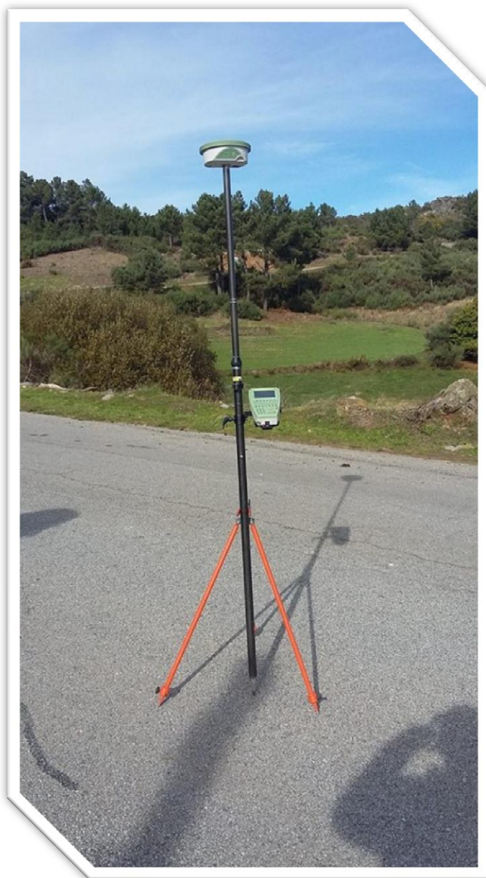
Figura 14 - Antena GNSS que se definiu como recetor móvel, sobre o bastão
