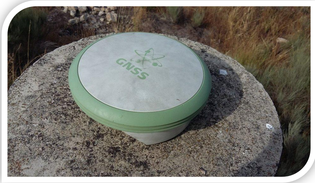
Figura 23 - Antena GNSS Base
