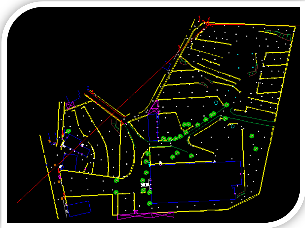
Figura 26 - Pontos levantados no Terreno
