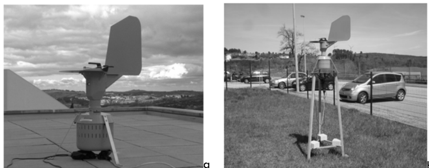
Figura 2 - Exemplo de um captador de pólenes do tipo Hirst colocado num telhado (a) e num suporte a 1,5 m do solo (b) no campus do IPG.
