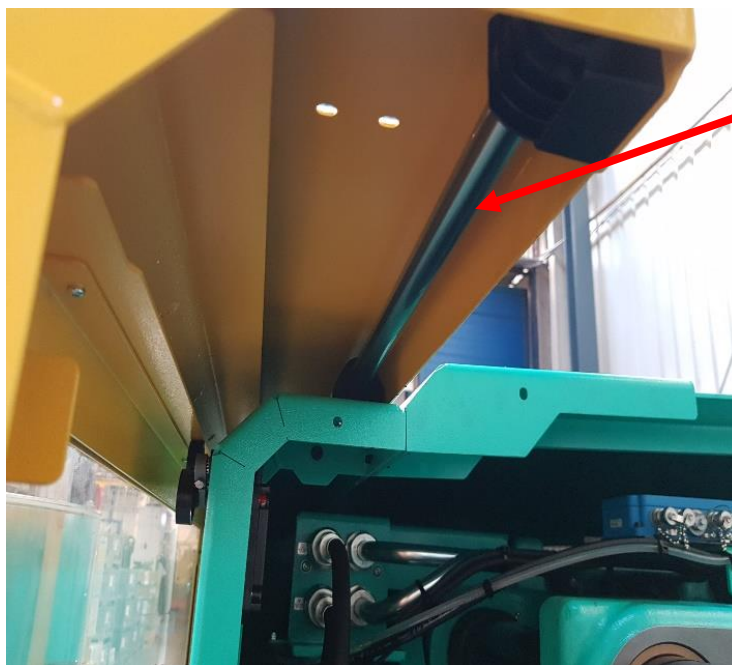
Figura 19 - Guias das portas de proteção
