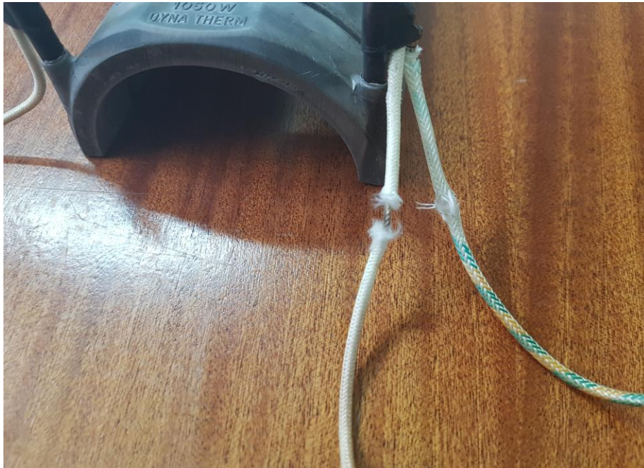
Figura 10 - Isolamento do fio condutor danificado
