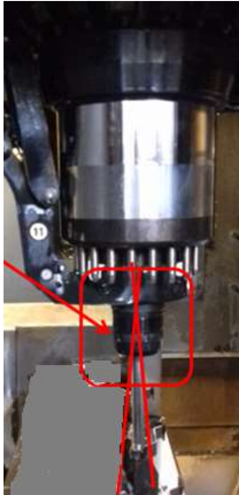
Figura 15 - Ferramenta mal fixada
