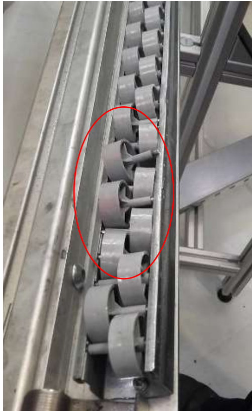
Figura 25 - Roletos danificados da colisão
