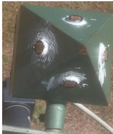
Figura 45: Pirâmide com as LDR. (Fonte: Própria)
