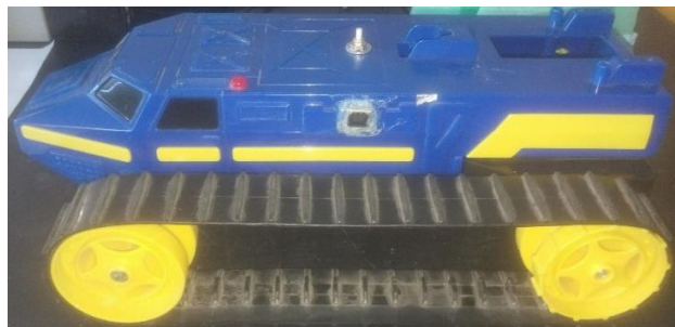
Figura 81: Robô com botão de arrancar e parar, led indicador de estado, porta USB do tipo B e botão para reinicializar as variáveis do código. (Fonte: Própria)
