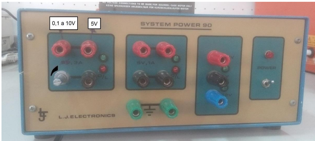
Figura 74: fonte de tensões fixas de 12V, 5V 1A, 5V 3A e variável de 0 a 10V 1A. (Fonte: Própria)
