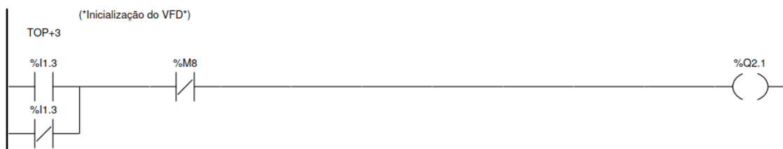
Figura 61: Introdução de uma memória com um contacto normalmente fechado. (Fonte: Própria)
