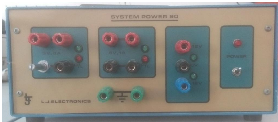
Figura 71: Fonte 12V, 5V 1A, 5V 3A, 0 a 5V 1A. (Fonte: Própria)
