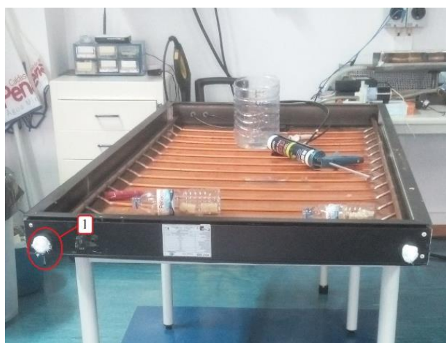
Figura 31: PVT com a parte térmica isolada. (Fonte: Própria)
