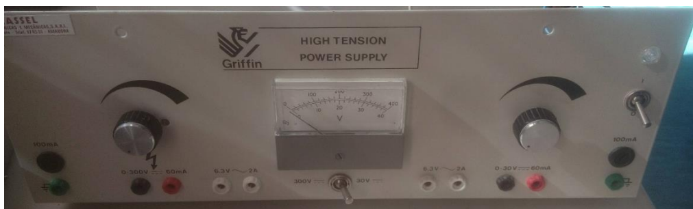
Figura 75: Fonte de alimentação 0/30V e 0/300V e com duas saídas fixas 6,3V 2A. (Fonte: Própria)
