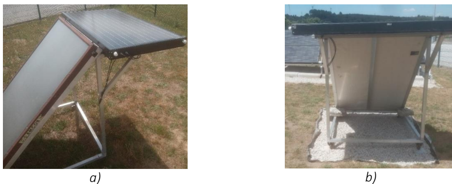
Figura 37: estrutura coletor térmico.
