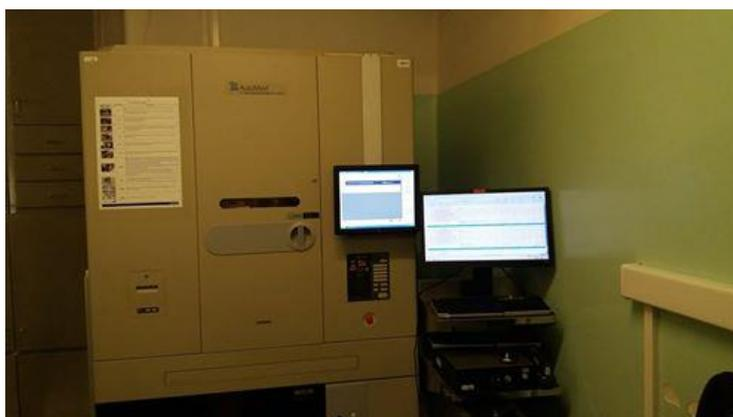
Figura 9 - Sistema semiautomático de dispensa de medicamentos - FDS
