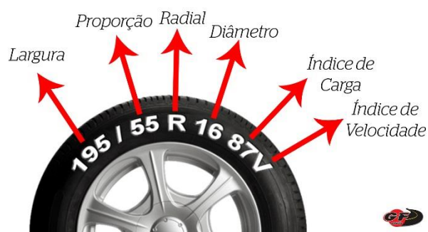
Figura 4 - Dimensões de um Pneu
