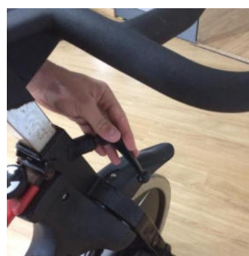
Figura 18 – Ajuste da altura do volante.
