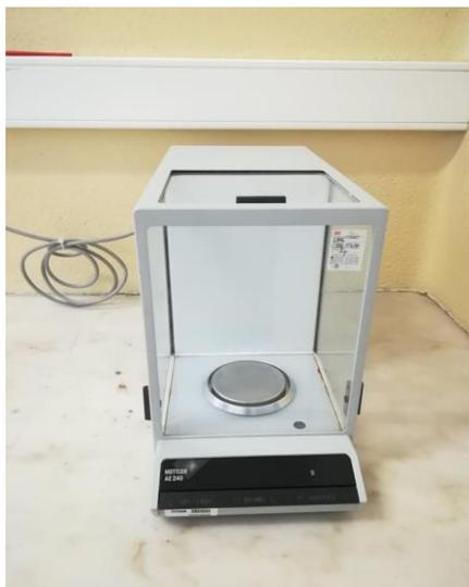
Figura 11 - Balança de precisão analítica
