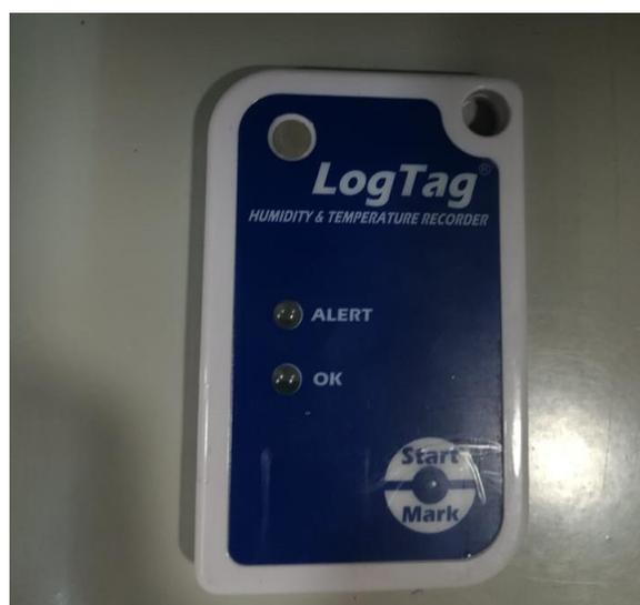
Figura 47 - Aparelho de medição da temperatura e da humidade
