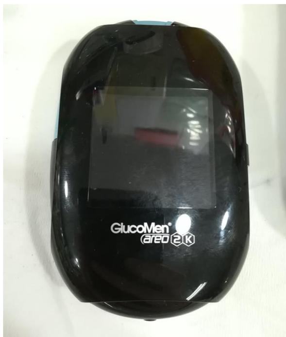
Figura 51 - Aparelho de medição da glicémia
