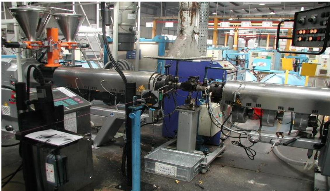
Figura 8: Processo de extrusão [3].
