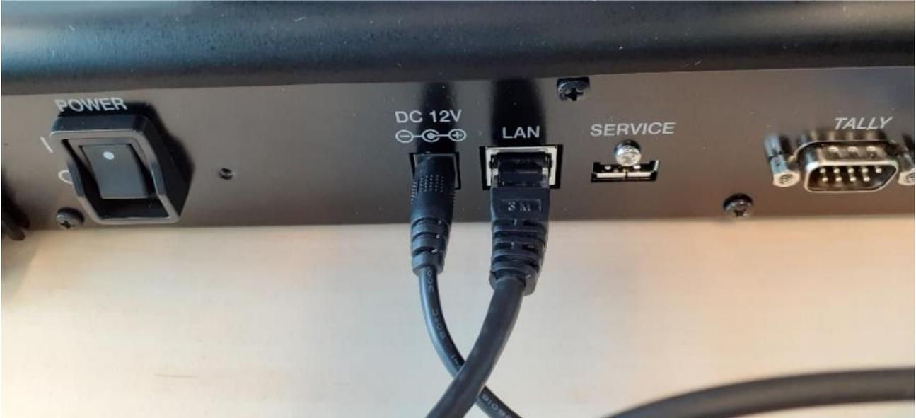
Figura 12-Porta LAN e entrada do transformador da mesa JVC PTZ (RM-LP100)
