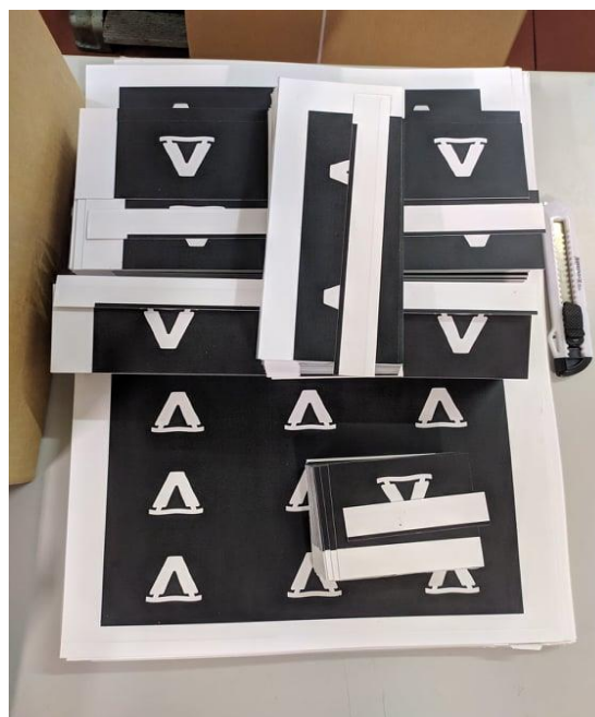
Figura 36 - Procedimento de corte de cartões de visita na guilhotina
