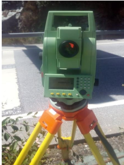
Imagem 21: Equipamento utilizado neste projeto, Estação Total Leica TCR803
