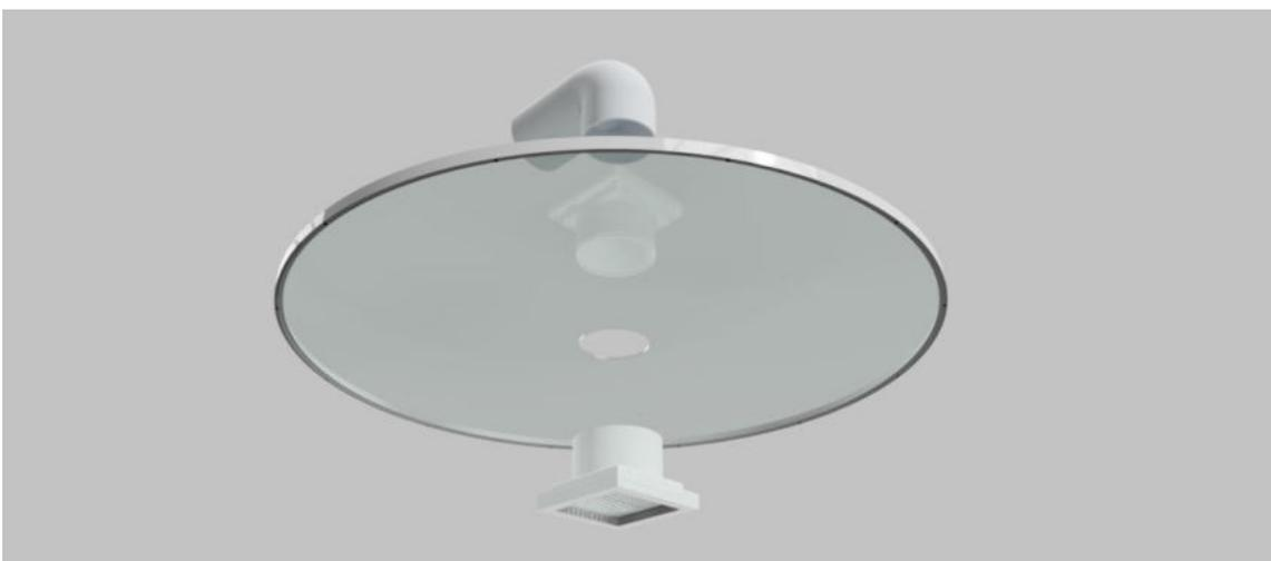
Fig. 66 – Montagem do extrator no orifício da placa acrílica
