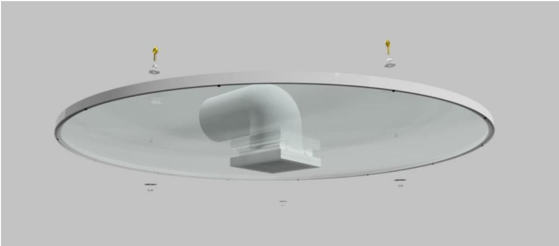
Fig. 67 – Explicação de montagem das anilhas, porcas e parafusos na placa acrílica
