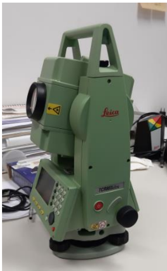
Figura 28- Estação Total Leica TCR803.
