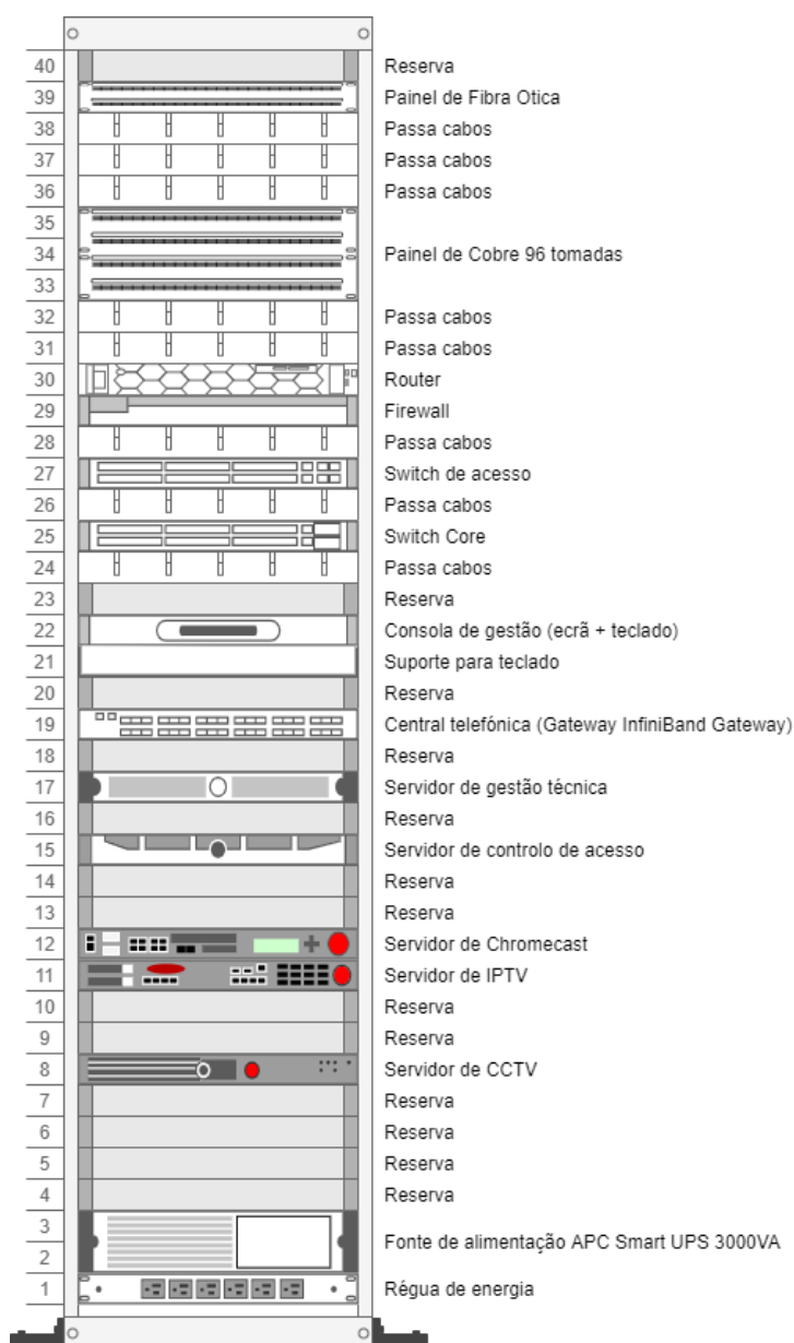
Figura 17 – Representação do bastidor de edifício (rés-do-chão)
