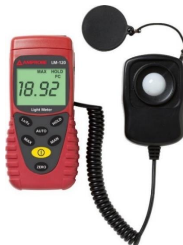
Figura 13: Luxímetro utilizado nas medições de fluxo luminoso (adaptado de AMPROBE®)
