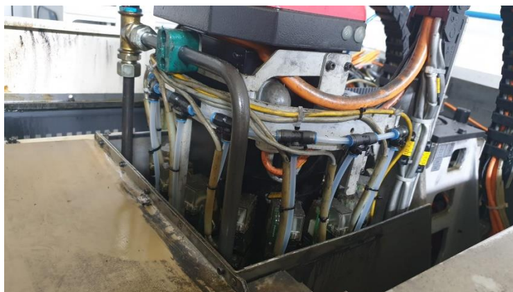
Figura 30- Circuito pneumático novo
