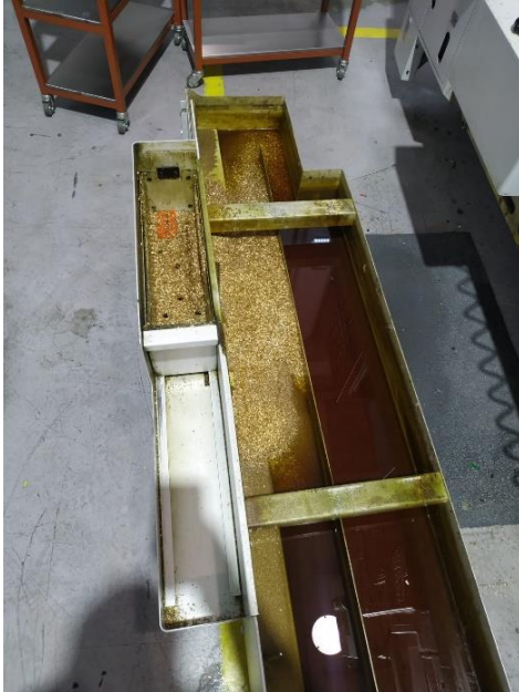
Figura 35- Tanque já sem limalhas e óleo
