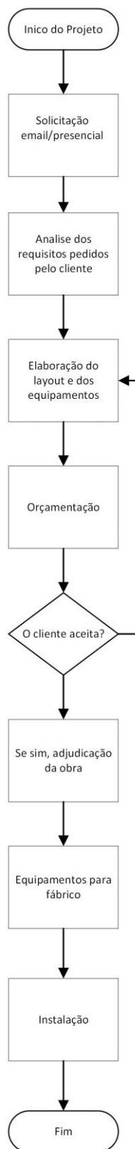
Figura 6 – Fluxograma de processo na criação de um projeto na Traçoinox.
