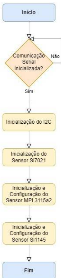
Figura 33 - Fluxograma Setup End Device - Estação Meteorológica
