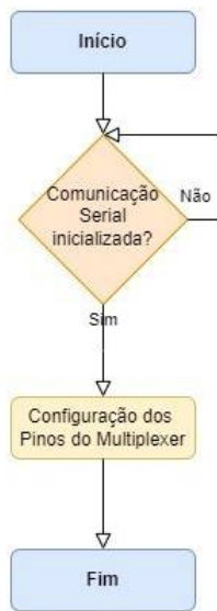
Figura 36 - Fluxograma Setup End Device - Estação Solar
