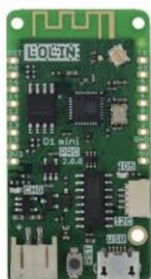
Figura 12-Microcontrolador Wemos D1 mini Pro ESP8266 [9]
