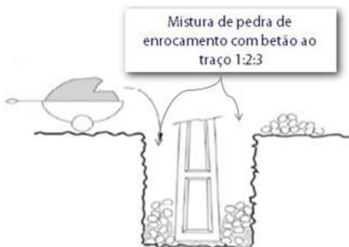
Figura 44 - Construção da fundação
