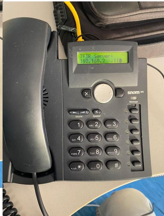
Figura 45 - Configuração do IP do servidor TFTP (portátil)
