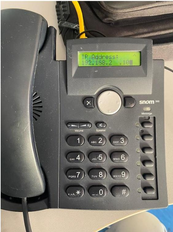
Figura 44 - Configuração do IP do VoIP
