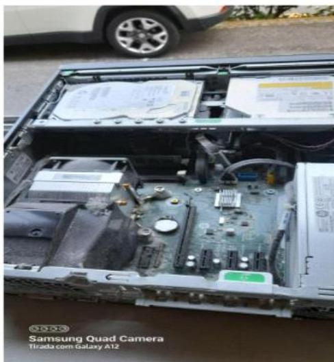
Figura 5 - Limpeza e mudar o HD para SSD.
