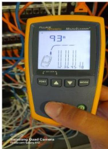
Figura 9 - Teste a um cabo de Rede.
