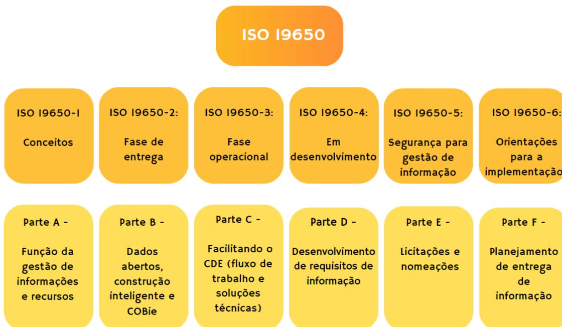
Figura 12: Estrutura de orientação da ISO 19650.
