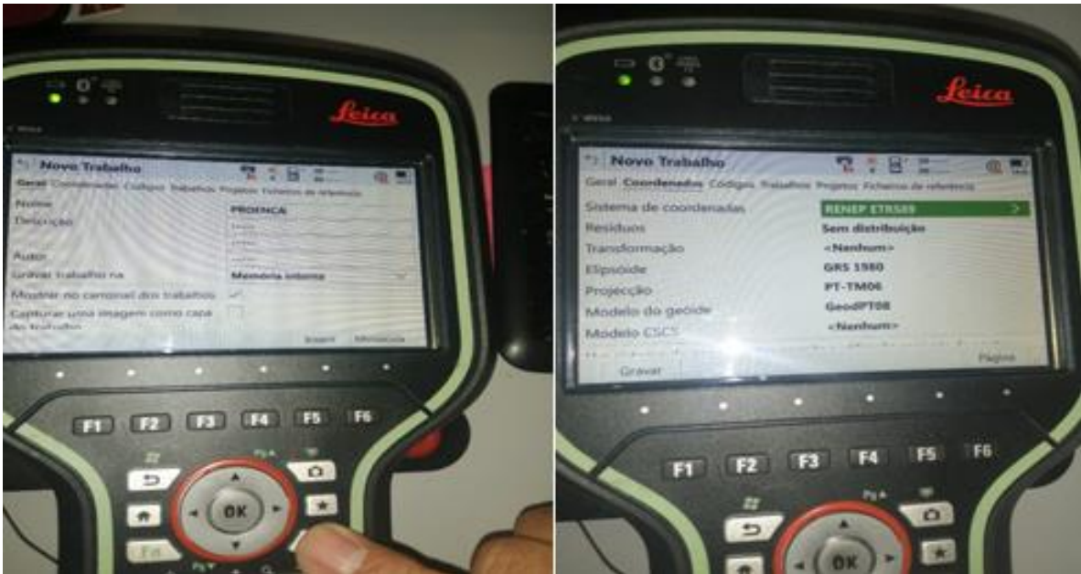
Figura 35: Criação de códigos para a antena GNSS GS18 I
