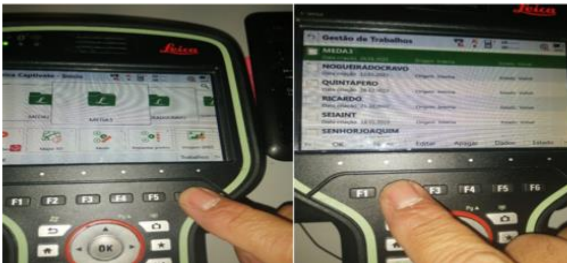
Figura 34: Criação de códigos para a antena GNSS GS18 I
