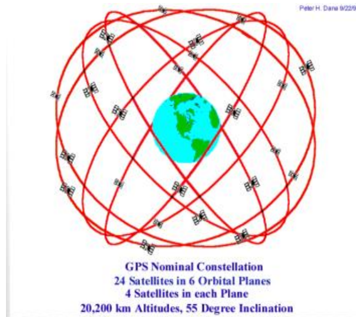
Figura 1: Constelação clássica do sistema GPS
