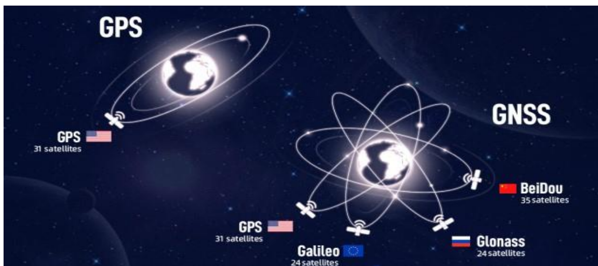
Figura 4: Diferença entre o sistema GPS e GNSS
