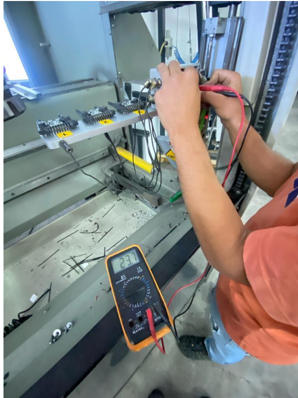
Figura 58 - Teste com multímetro do sensor indutivo sem o cone introduzido
