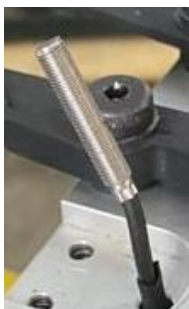
Figura 40 - Sensor indutivo de detecção de ferramenta no armazém de ferramentas
