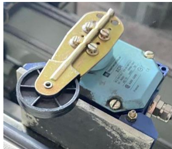
Figura 44 - Fim de curso do cilindro pneumático da proteção frontal
