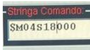
Figura 82 - Comando ISO de rotação do mandril a 18000 rpm
