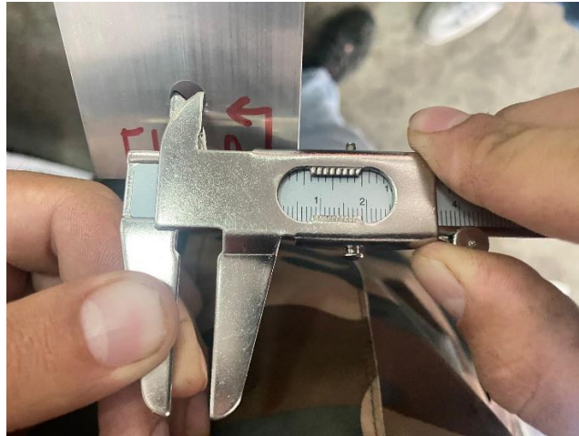
Figura 89 - Medição do diâmetro do furo
