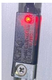
Figura 41 - Funcionamento de sensor indutivo [19]
