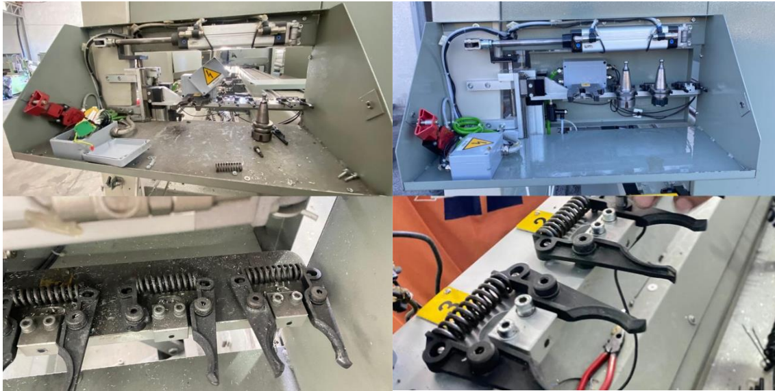
Figura 57 - Requalificação do armazém de ferramentas
