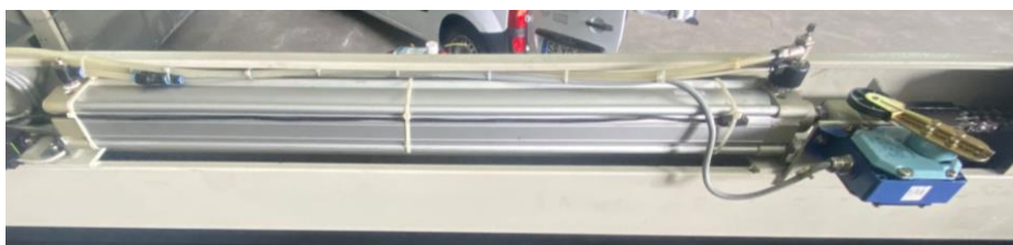
Figura 56 - Cilindro pneumático substituído
