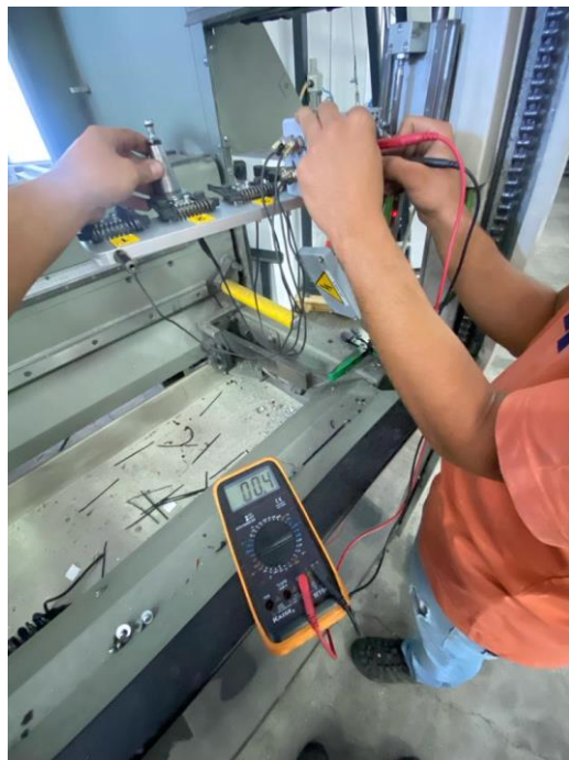
Figura 59 - Teste com multímetro do sensor indutivo com o cone introduzido
