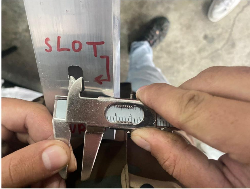
Figura 91 - Medição da largura do slot
