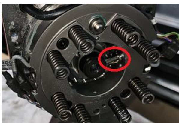
Figura 43 - Sensor indutivo de detecção de ferramenta no mandril
