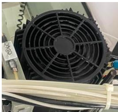
Figura 53 - Substituição do sistema de arrefecimento do mandril (ventilador)
