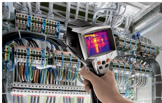
Figura 21 - Testes de temperatura a ligações elétricas [17]
